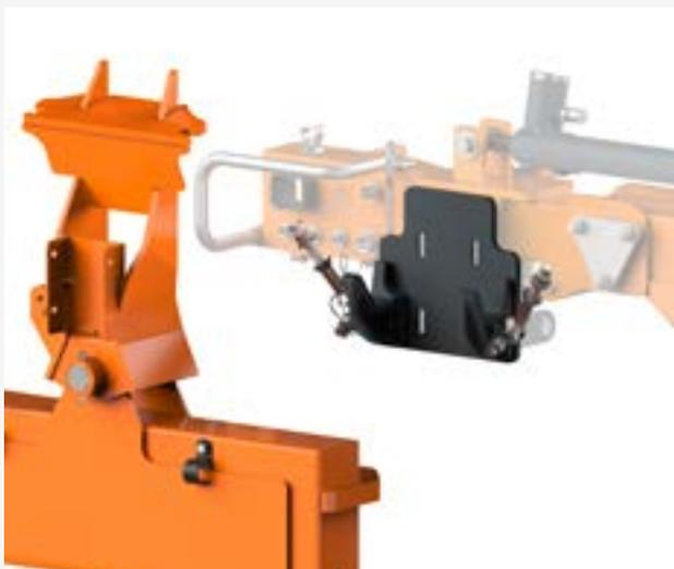
*Das Anbaugerät wird von zwei an der Anbauplatte angeordneten Haken getragen.*
