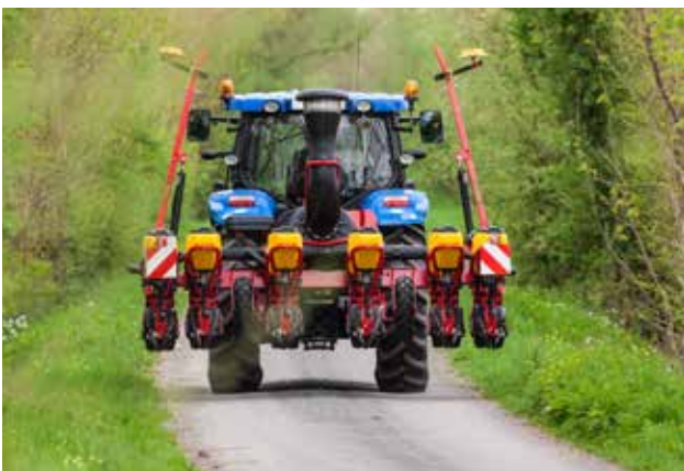
Tempo T ist erhältlich mit Transportbreiten zwischen 3,3 m und 3,5 m. Dies sorgt für einen kleinen Kurvenradius und komfortablen Transport.
