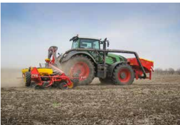
Der vorn angebaute Fronttank FH 2200 ermöglicht eine schlagkräftige Kombiassaats.
