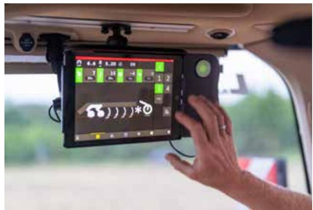
*Die Ausstattung des TopDown mit dem iPad-basierten E-Control-System ermöglicht die vollständige Kontrolle und die Vorgabe von Bodenbearbeitungsdaten.*
