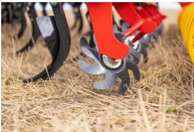
Das automatische Nivellierungssystem Dynamic Control sorgt dafür, dass die Nivellierer immer in der optimalen Position arbeiten.
