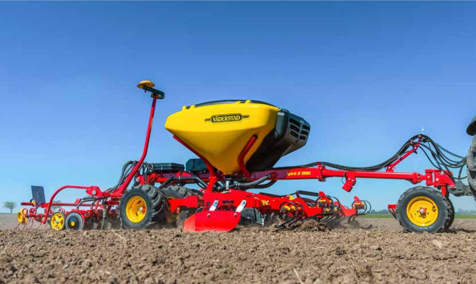
Spirit R 300S ist eine pneumatische Sämaschine mit 3 m Arbeitsbreite.
