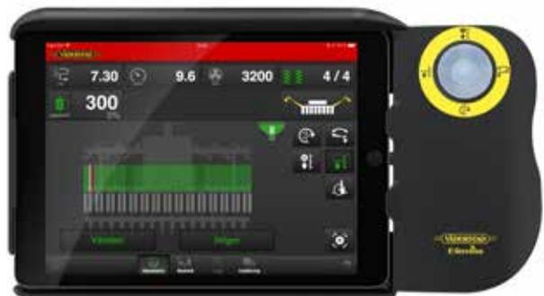
Die Spirit 400C/S nutzt das iPad-basierte Steuersystem E-Control zur Überwachung und Steuerung des Sävorgangs.
