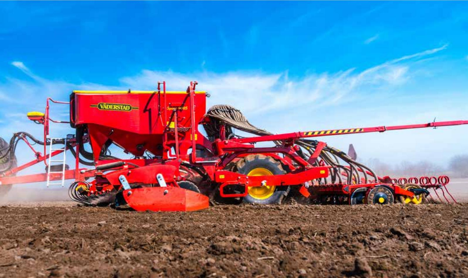
Die pneumatische Drillmaschine Spirit 600-900S ist eine reine Saatgutaussaat mit 6, 8 oder 9 Metern Arbeitsbreite.
