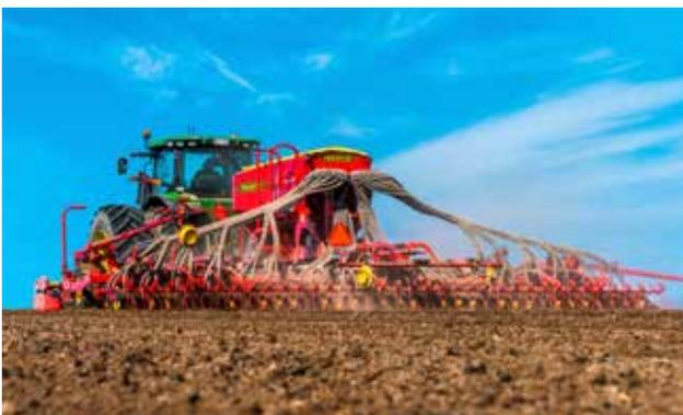
Spirit 600-900S ermöglicht es dem Fahrer, die Halbseitenabschaltung direkt vom Fahrersitz aus durchzuführen.
