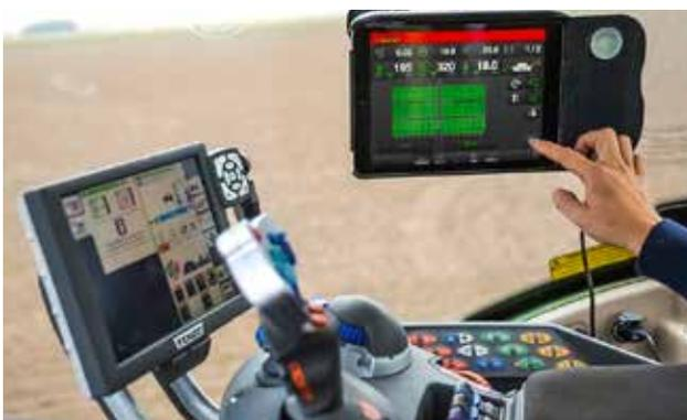
Das Saatgut wird von zwei Fenix III Dosiereinheiten dosiert, wobei jede für eine Halbseite der Maschine zuständig ist, sodass die halbe Maschine von der Kabine aus abgeschaltet werden kann.
