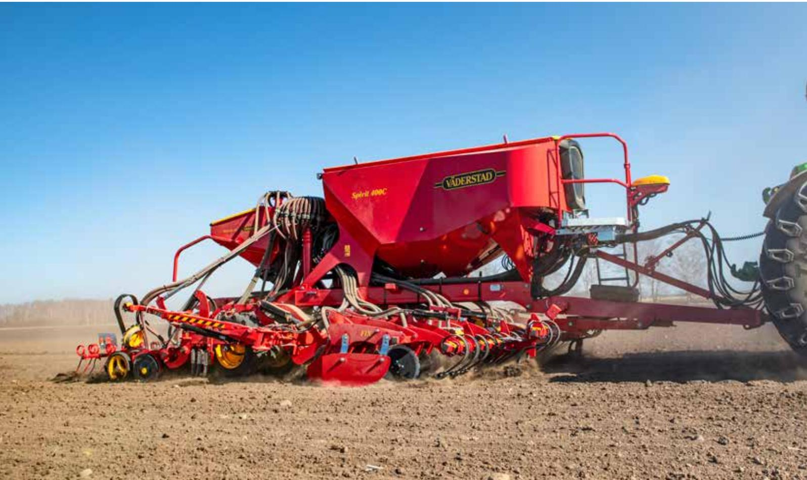
Spirit 400 ist eine 4 Meter breite pneumatische Sämaschine, die entweder als reine Sämaschine Spirit 400S oder als Kombiversion Spirit 400C erhältlich ist.
