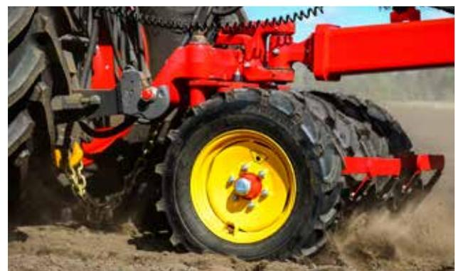
Der optionale Zwischenreifenpacker verfestigt den Boden zwischen den Traktorrädern, sodass jedes Saatgut die gleichen Keimbedingungen erhält.
