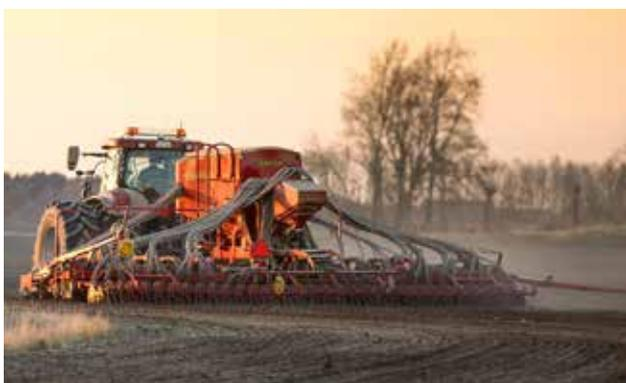
Um die Leistung auf dem Feld zu optimieren, ist Spirit 600-900C mit einer Halbseitenabschaltung für Saatgut und Dünger ausgestattet.
