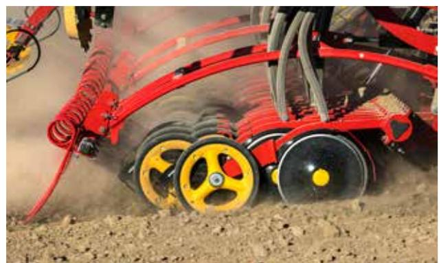
Der Säschardruck, die Arbeitsintensität der Vorwerkzeuge oder der Druck des Nachstriegels lassen sich von der Kabine aus bequem einstellen.
