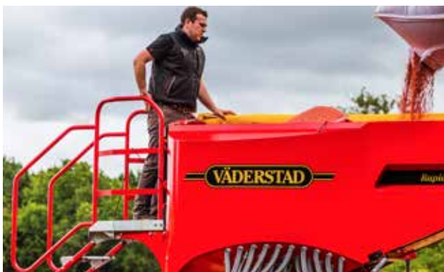
Die Rapid A 400-800S verfügt über eine zentrale Plattform mit beidseitigem Zugang, was dem Fahrer Arbeitszeit spart.
