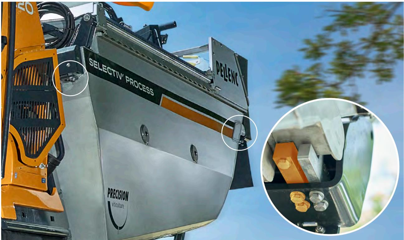
Die Behälter sind jeweils mit 4 Wiegevorrichtungen ausgestattet, die sehr robust und vollständig in die Erntekopfbaugruppe integriert sind.
