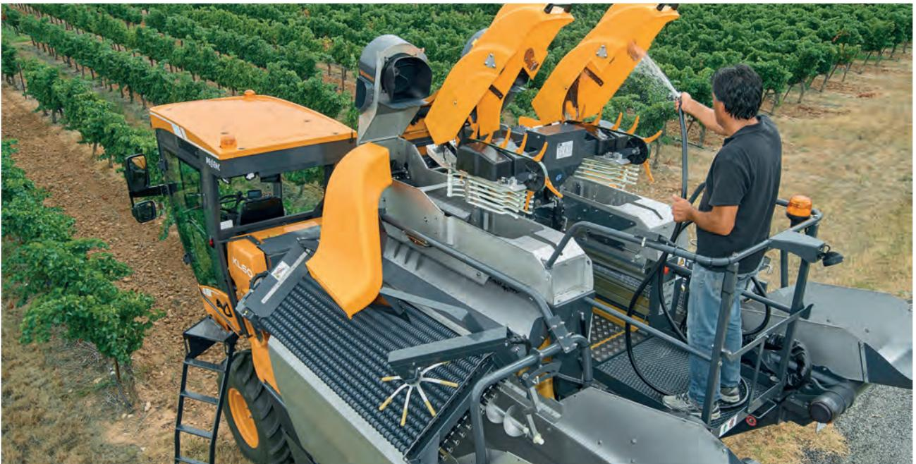
Direkter Zugang zu allen Elementen des Erntekopfs von der sicheren Plattform aus
