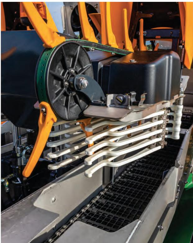
Lineare Abbeermaschine mit 5 langen Fingerpaaren
