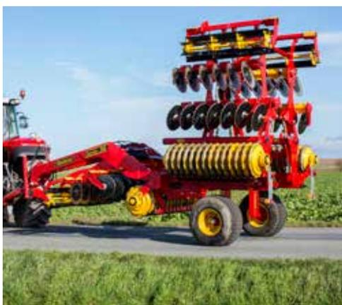
*Dank der einzigartigen Klappung besitzt Carrier 420-820 einen niedrigen Schwerpunkt, gute Manövrierfähigkeit beim Transport sowie eine ausgezeichnete Konturanpassung im Feld.*
