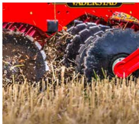
*Zwei Reihen aus hochwertigen V-55 Schwedenstahl-Scheiben arbeiten bis zu einer Arbeitstiefe von 12 cm.*
