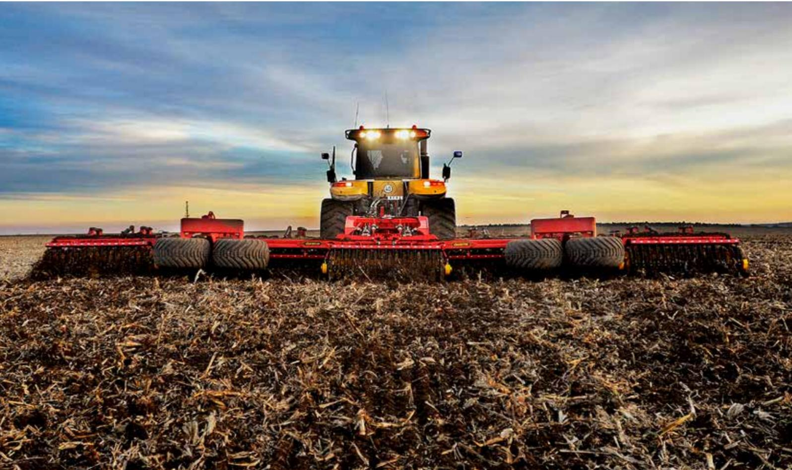
Bei hoher Arbeitsgeschwindigkeit hat die Carrier XL 925-1225 eine Arbeitsleistung von bis zu 16 Hektar pro Stunde. Das senkt die Arbeitskosten pro Hektar auf ein Minimum.
