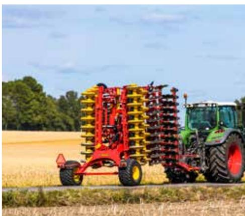
Beim Transport der Carrier XL 425-725 zwischen den Feldern wird die Maschine auf eine Transportbreite von 3 m eingeklappt.
