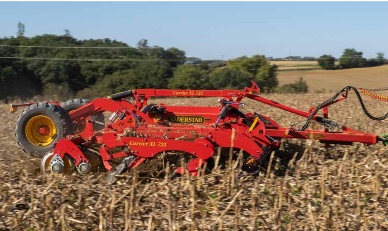
Carrier XL 426-725 kann mit 510- oder 610-mm-Scheiben mit verstellbaren Scheibenwinkeln bestückt werden.
