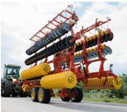
*Dank der einzigartigen Klappung besitzt Carrier 925-1225 einen niedrigen Schwerpunkt, gute Manövrierfähigkeit beim Transport sowie eine ausgezeichnete Konturanpassung im Feld.*
