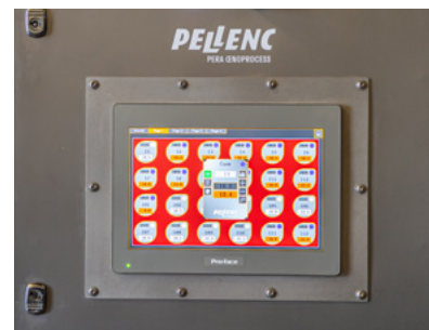
Steuerbildschirm einer Maischeerhitzung mit Flash-Entspannung
