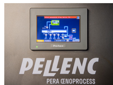
Steuer- und Bedienelemente der Warmwassererzeugung
