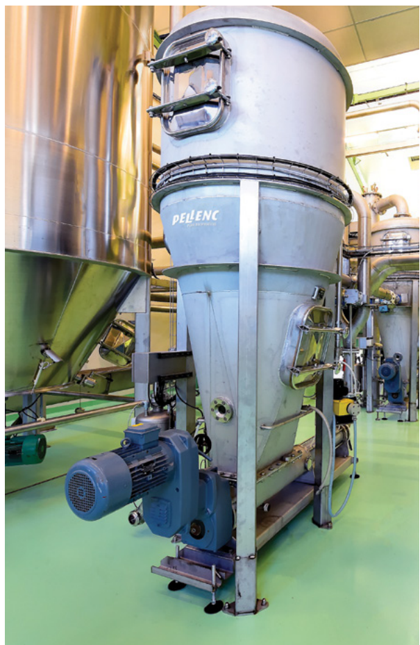
Entspannungskammer 7 t/h mit Kondensator
