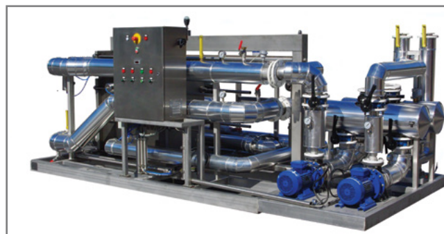
Skid zur Weinstein-Stabilisierung mit Steuerung per PELLENC PERA CENOPROCESS-Automatik
