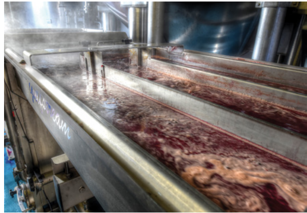
Heizkreislauf des Leseguts
