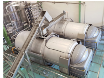
Abstich-System und Zufuhr des vergorenen Tresters in die Pressen
