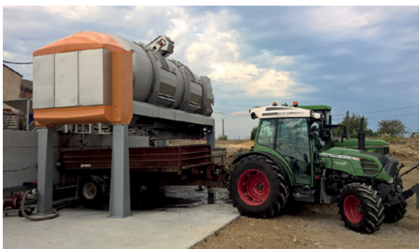
Direktes Entleeren in die Mehrfachwannen unter der Presse
