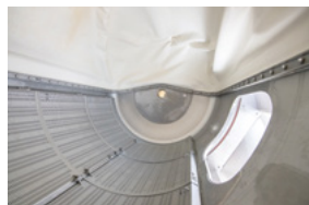
SPC – Innenbereich der Presse ohne schwer zu reinigende Stellen
