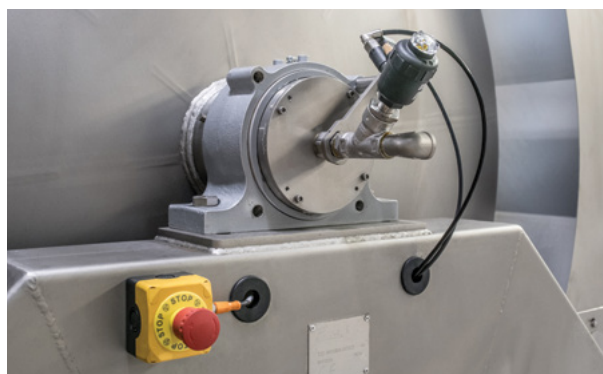
Wassereinspritzsystem für die automatische Reinigung
