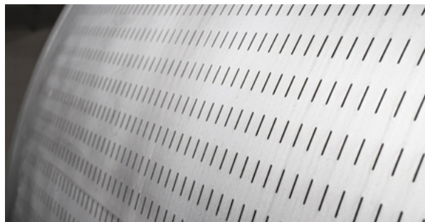
Stanzloch tank = kein Reibeffekt und besser zu reinigen
