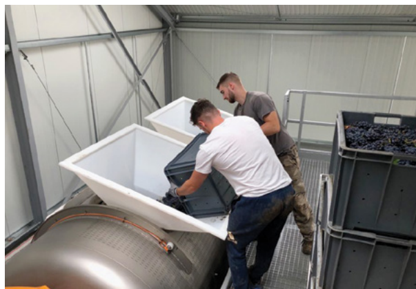
Beschickung der Presse über die Türen
