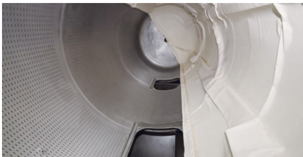
Innenansicht eines Stanzloch tanks mit Membran und Windungen zum Zentrieren des Tresters
