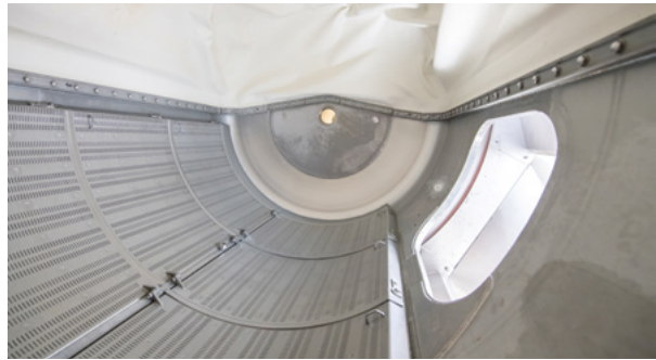
SPC - Innenbereich der Presse ohne schwer zu reinigende Stellen
