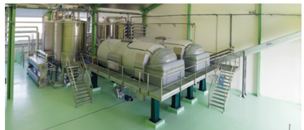
Entleeren in Tresterförderschnecke unter der Presse
