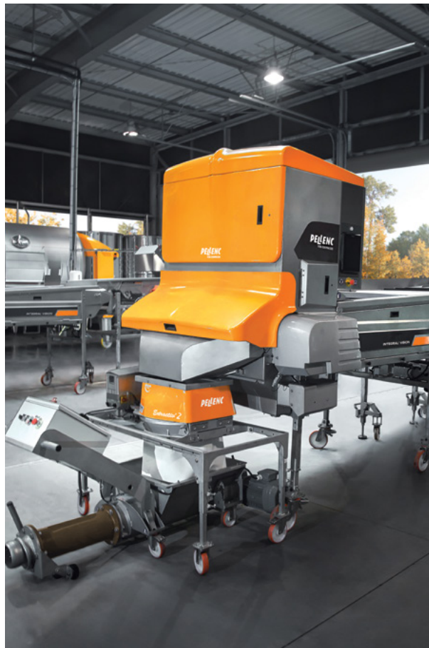
Extractiv'2 auf Rollrahmen am Auslass von Integral' Vision
