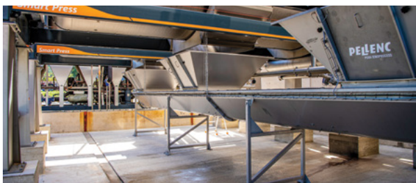
Entleeren in Tresterförderschnecke unter der Presse
