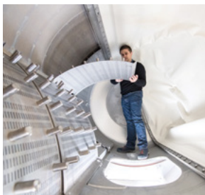
SPC – Einfach zu öffnende Fast-Press-Gitter
