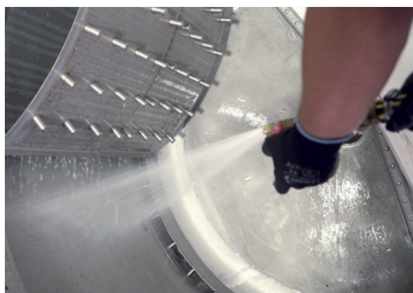
Aufklappbare Drainagegitter Fast Press für eine einfache Reinigung
