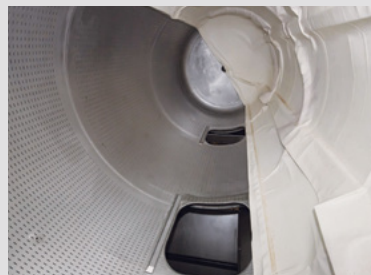
Innenansicht eines Stanzlochtanks mit Membran und Windungen zum Zentrieren des Tresters
