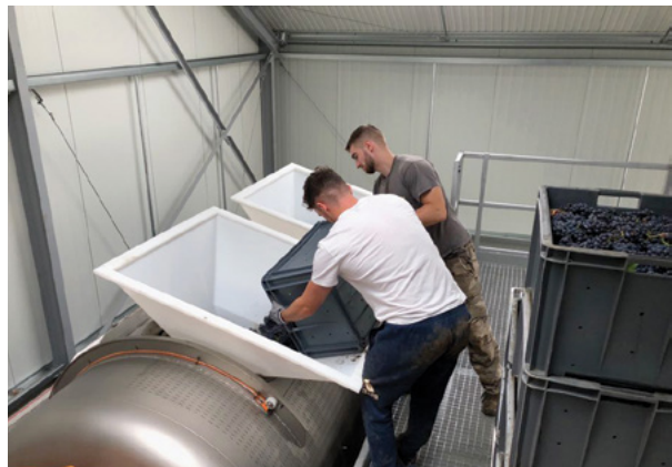
Beschickung der Presse über die Türen
