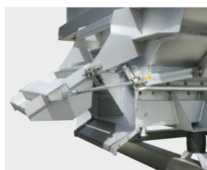
Durch Pneumatikzylinder betätigte, dichte Türe
