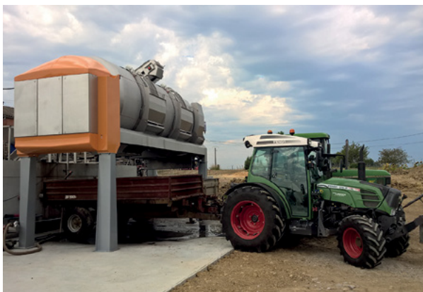
Direktes Entleeren in unter der Presse abgestellte Anhänger
