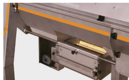
Unter eine Abbeermaschine H400 montierte Traubenmühle F10
