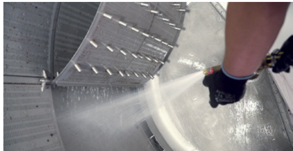
Aufklappbare Drainagegitter Fast Press für eine vereinfachte Komplettreinigung
