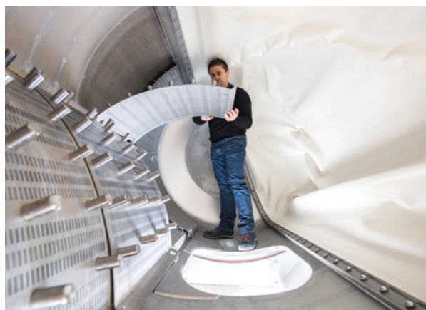
SPC – Einfach zu öffnende Fast-Press-Gitter
