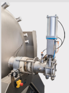
Axialer Einlass mit Pneumatikventil
