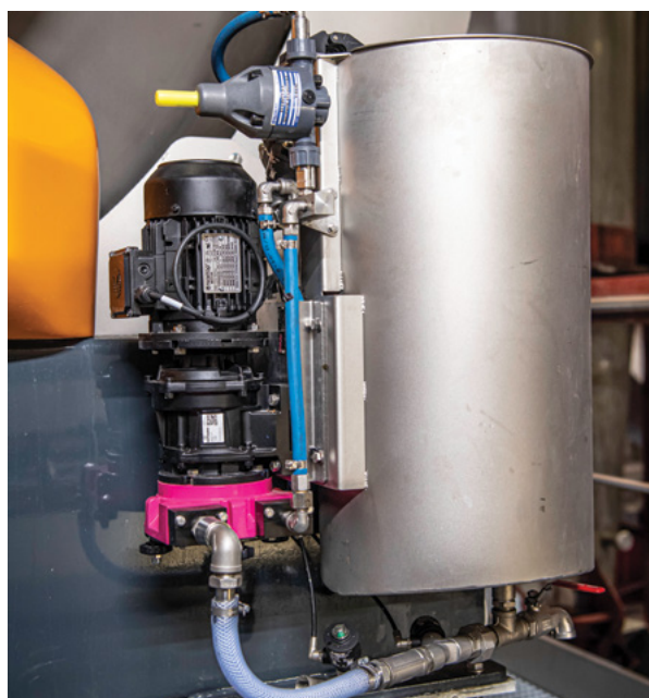
Neues Injektionssystem für flüssige önologische Zusätze
