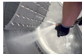
Aufklappbare Drainagegitter Fast Press für eine vereinfachte Reinigung
