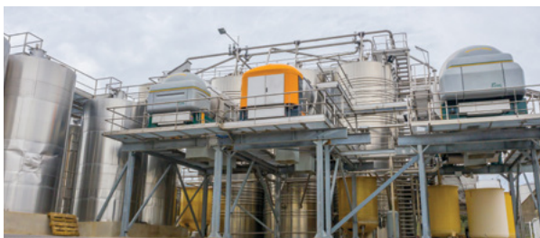
Direktes Entleeren in die Mehrfachwannen unter der Presse
