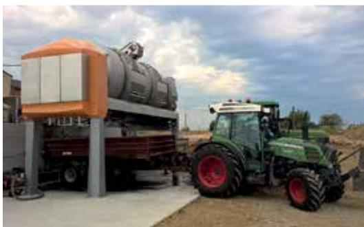
*Direktes Entleeren in die Mehrfachwannen unter der Presse*
