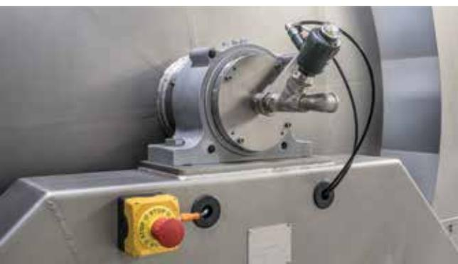
Wassereinspritzsystem für die automatische Reinigung
