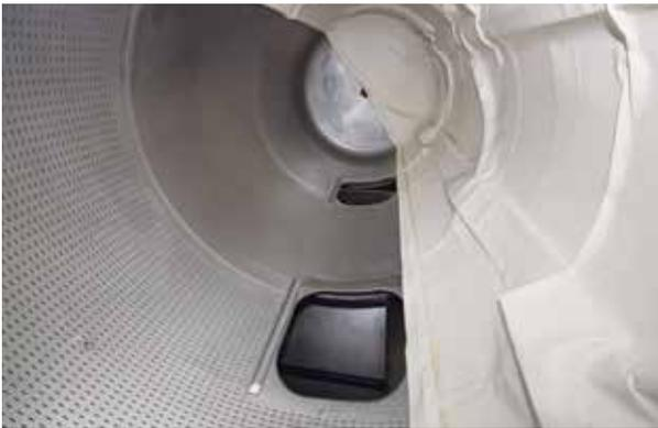
Innenansicht eines Stanzlochtanks mit Membran und Windungen zum Zentrieren des Tresters
