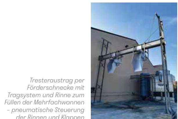
*Tresteraustrag per Förderschnecke mit Tragsystem und Rinne zum Füllen der Mehrfachwannen – pneumatische Steuerung der Rinnen und Klappen*
