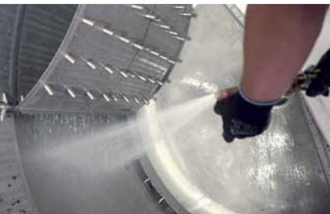
Aufklappbare Drainagegitter Fast Press für eine einfache Reinigung
